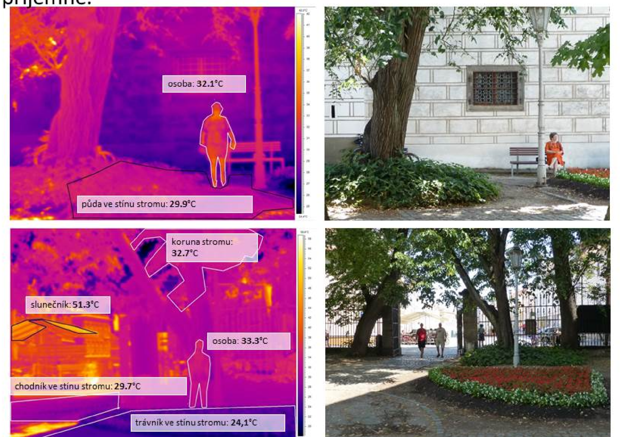
Obr. 3: Slunečnick za osobami ve venkovní restauraci má teplotu 51,3 °C, zatímco koruna stromu má teplotu 32,7 °C. Prostor pod slunečnickem má teplotu 36,3 °C (viz Obr. 2), zatímco trávnik pod stromem dosahuje teploty pouze 24,1 °C.
